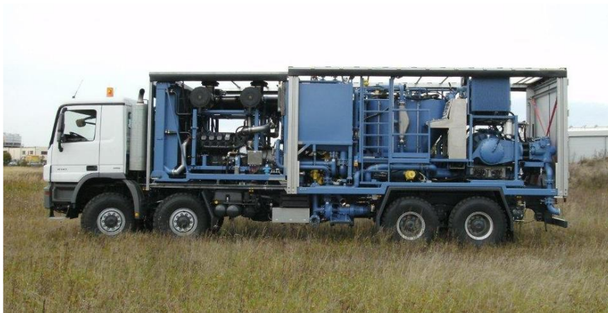
Мобильный цементирующий комплекс УНБ2-1000х75: опытный экземпляр, со снятым защитным тентом, на заводских испытаниях
